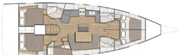
Il bagno a dritta della versione standard è sostituito da una cabina con i letti a castello:
