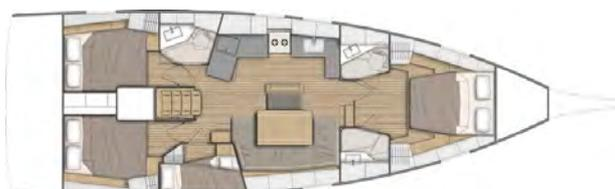
Il bagno a dritta della versione standard è sostituito da una cabina con i letti a castello:
